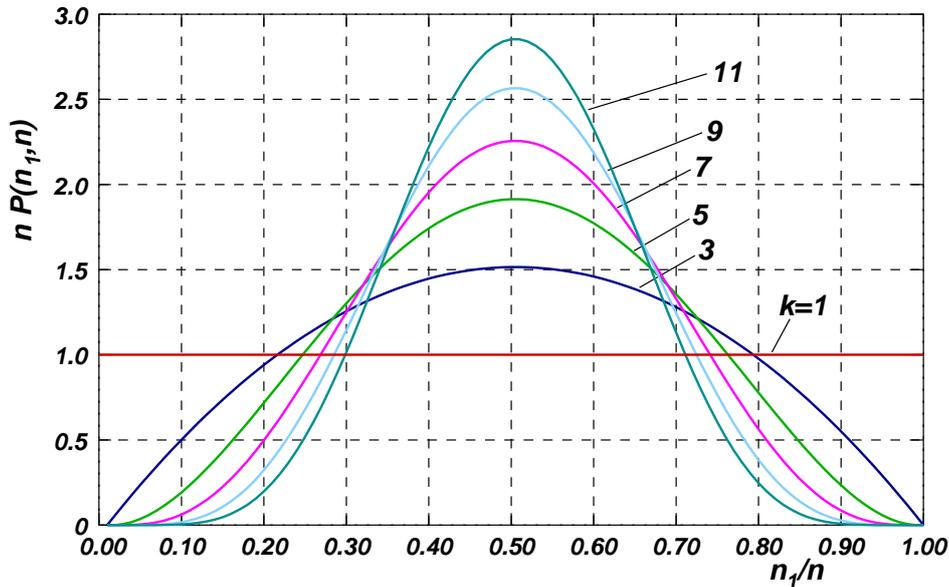
Figura 5.6: Probabilidad de que el pivote aparezca en una dada posición  $n_1$ , para diferentes valores de  $k$ .
