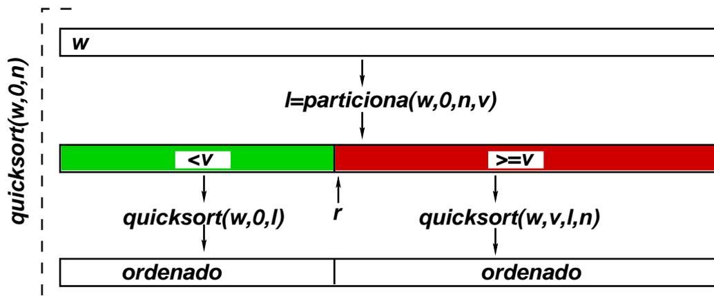
Figura 5.2: Esquema “dividir para vencer” para el algoritmo de ordenamiento rápido, quick-sort.
